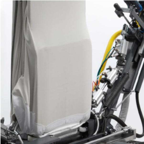
**Dispositivo di tensionamento posteriore**
